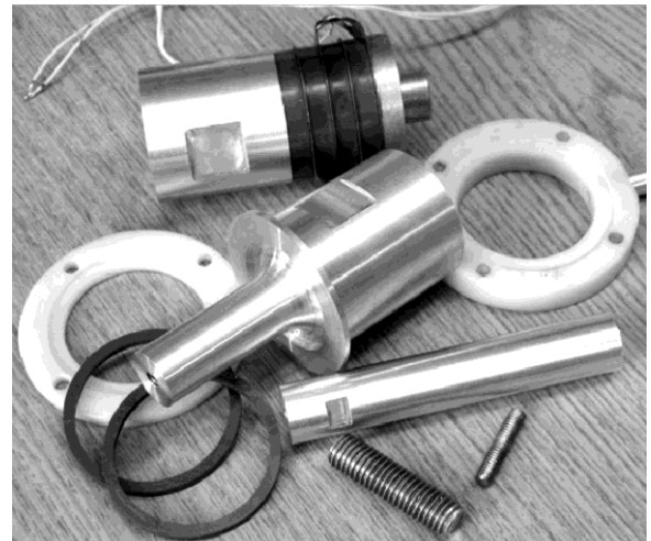
Рис. 2 – Складові елементи типового однохвильового УЗ-диспергатора, виконаного з симетричним пакетним ПЕП [5]
