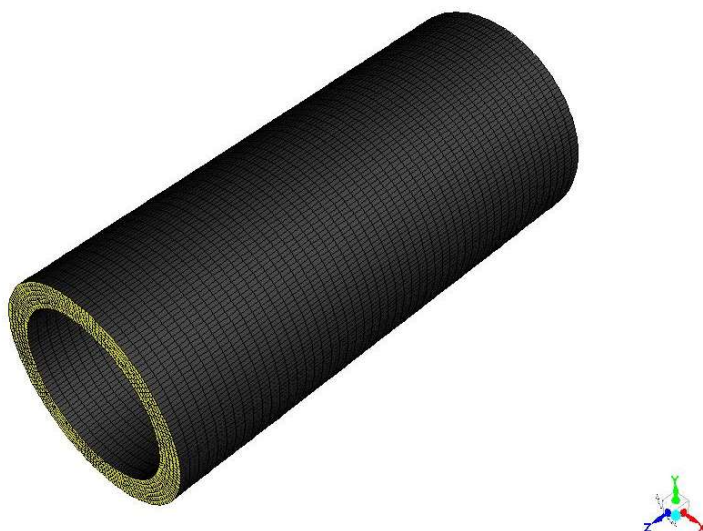
Рис. 3 – Модель геометрії циліндричної зони віскозиметра
