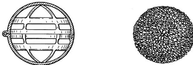
Рис. 14 – Насадка у вигляді сферичної оболонки з прорізами й розташованим у ній волокнистим наповнювачем (пат. US6631890B1)
