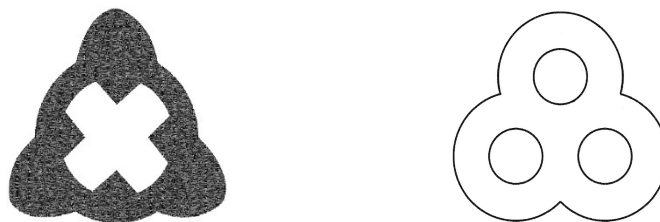
Рис. 34 – Умовно призматичні насадки з поперечним перерізом у вигляді порожнистих правильних опукло-увігнутих трикутників (пат. № EP3431178A1, EP3659703A1, заявка WO2020/108872A1)
