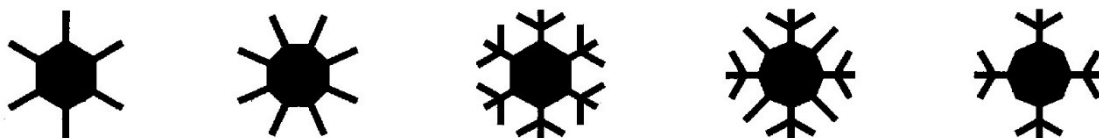
Рис. 5 – Насадка у вигляді правильних прямих призм із зовнішніми поздовжніми ребрами (вигляд з боку однієї з основ; пат. № PT3294432T)
