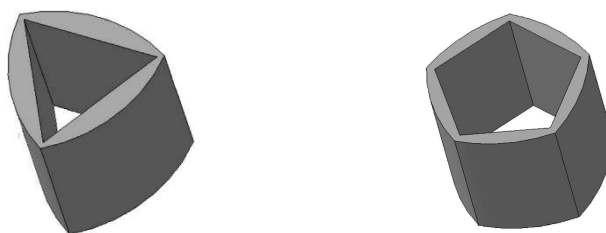
Рис. 32 – Умовно призматична насадка постійної ширини з порожнинами у формі прямих правильних призм (пат. № RU210652U1, RU211779U1)
