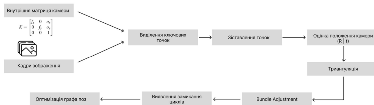
Рис. 1 – Загальна схема роботи SLAM на основі оптимізації
