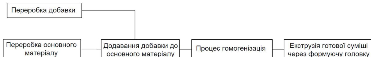
Рис. 2 – Принципова схема переробки полімерної суміші
